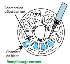
2. Ne remplissez pas trop le disque. Si le disque est trop rempli, l'échantillon d'eau s'écoulera du trou d'aération au centre du disque. Si cela se produit, l'échantillon d'eau peut s'écouler prématurément dans une chambre de réactif et les résultats ne seront pas précis. Commencer un nouveau test dans la chambre suivante.
