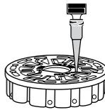
1. Remplissez toutes les sections non utilisées du disque, d'une pression lente et uniforme. Ajoutez de l'eau d'échantillon jusqu'à ce que la chambre de blanc soit remplie et la chambre de débordement le soit partiellement.
