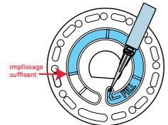
4. Ne créez aucune bulle d'air dans le disque. Les chambres de réactifs ne seront pas entièrement remplies et les résultats seront inexacts. Dès qu'une bulle commence à se former, tirez sur le piston pour tirer la bulle du disque. Recommencez le processus de remplissage.
