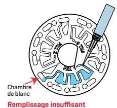
4. Ne créez aucune bulle d'air dans le disque. Les chambres de réactifs ne seront pas entièrement remplies et les résultats seront inexacts. Dès qu'une bulle commence à se former, tirez sur le piston pour tirer la bulle du disque. Recommencez le processus de remplissage.
