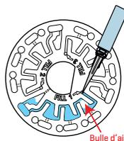
5. Les disques humides doivent être séchés minutieusement avec une lingette non pelucheuse. Manipulez le disque en le tenant par les bords. Entre deux analyses, stockez le disque sur une surface plane. N'agitez pas un disque partiellement rempli afin d'éviter toute fuite et toute contamination. Les disques ayant été partiellement utilisés doivent être jetés à la fin de la journée.
