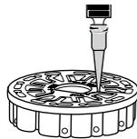
1. Remplissez le disque d'une pression lente et uniforme. L'eau d'échantillon remplit les espaces entre les cloisons dans le sens inverse des aiguilles d'une montre. Chaque espace se remplit du bas vers le haut. Versez de l'eau d'échantillon jusqu'à ce que les quatre chambres soit remplies **jusqu'en haut**, juste au-dessus de la ligne de remplissage en relief. Ce n'est pas grave si l'eau dépasse légèrement la ligne de remplissage.
