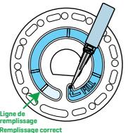
2. Ne remplissez pas trop le disque. Si le disque est trop rempli, l'eau d'échantillon débordera de la cavité de débordement située au centre du disque. Le disque ne fuit pas. Séchez le disque et lancez le test.
