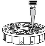
1. Llene las secciones no utilizadas del disco ejerciendo lentamente una ligera presión. Añada la muestra de agua hasta que la Cámara vacía se llene y la Cámara de flujo excesivo se llene parcialmente.
